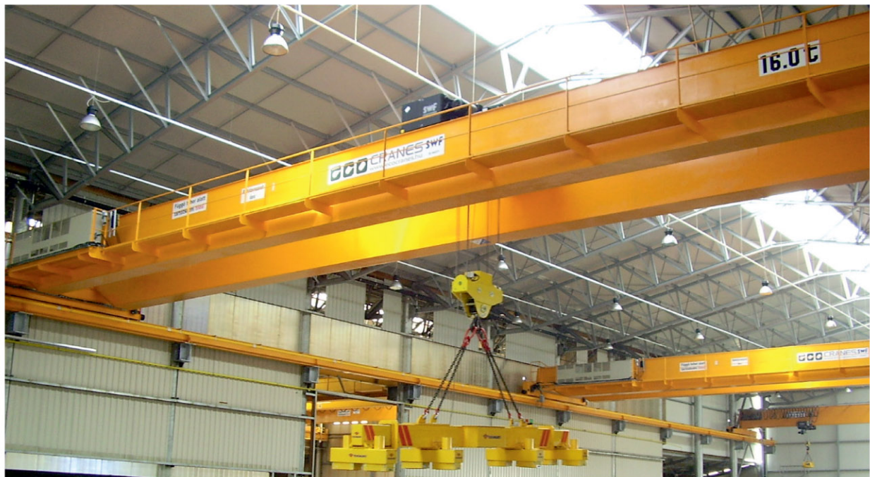
16t-ás kétfőtartós daru elektromágneses megfogóval
