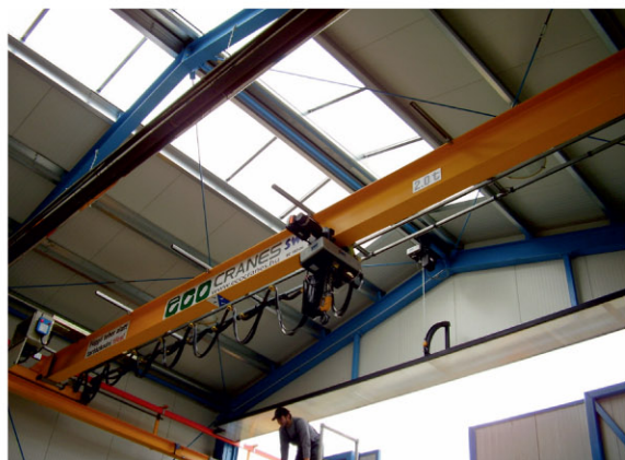
2t-ás egyfőtartós daru villamos láncos emelőművel
